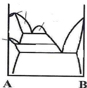
7. Постройте изотермический разрез системы при температуре Т2 и укажите фазы.
