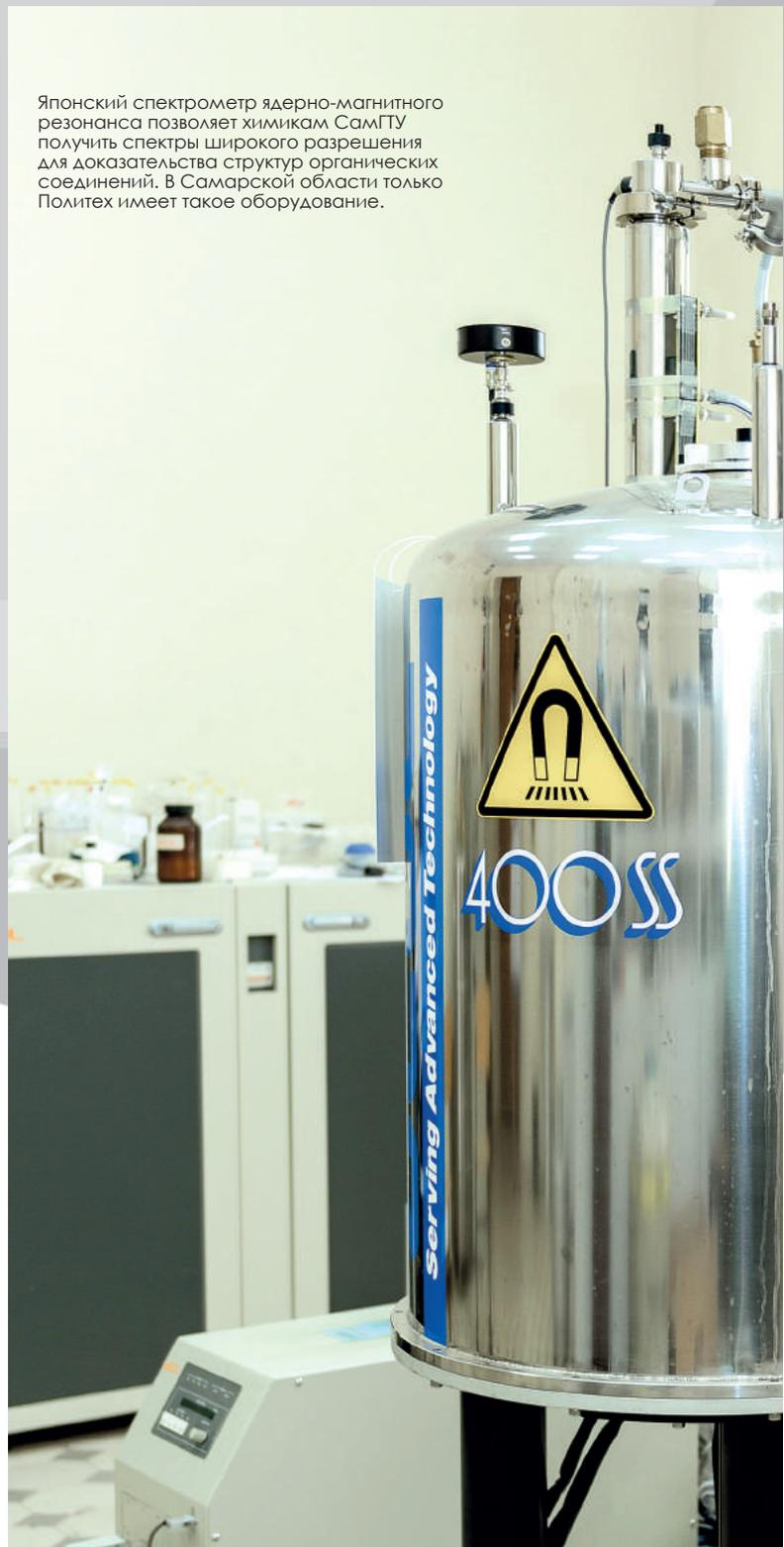
Японский спектрометр ядерно-магнитного резонанса позволяет химикам СамГТУ получить спектры широкого разрешения для доказательства структур органических соединений. В Самарской области только Политех имеет такое оборудование.
